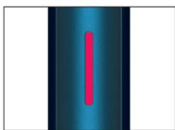
Crveno LED svetlo na indikatoru statusa treperi 3 sekunde, a uređaj istovremeno vibrira 3 puta. Nivo baterije je nedovoljan. Napunite uređaj.
