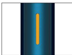
Naranđasto LED svetlo na indikatoru statusa treperi 3 sekunde. Nakon 3 uzastopna korišćenja, uređaj počinje automatski da se hlađi. Sačekajte dok se temperatura uređajane stabilizuje.
