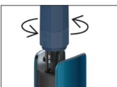
Ubacite brisač u uređaj i čistite uređaj tako što ćete okretati brisač.
