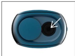
Proverite da li ima ostatak u otvoru za ubacivanje patronе.
