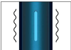
Kad je uređaj aktiviran, LED indikator statusa treperi svetlo-plavo jednu sekundu, dok uređaj istovremeno vibrira dvaput.
